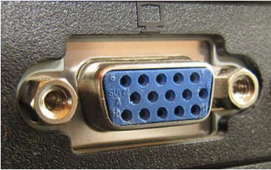
VGA-Anschluss (Video Graphics Array) Für 15-poligen Mini-D-Sub-Stecker (VGA-Stecker).
